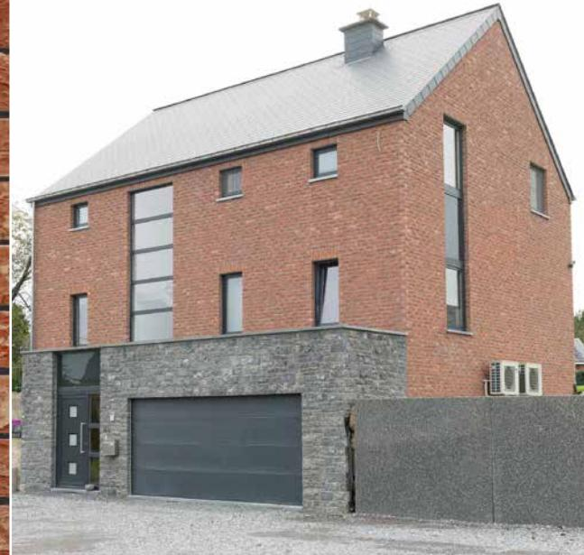
Deze handvormgevelsteen wordt vervaardigd van Lössleem, onder meer gewonnen uit het plateau van Kesselt in de Maasvallei (België) en opgewaardeerd met grondstoffen uit de Vulkan-Eifel.
