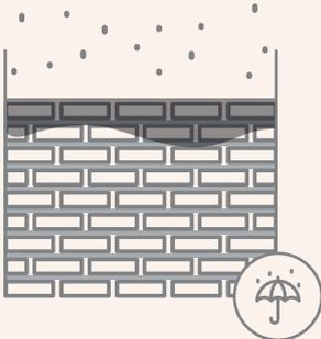
**NL N70 is een exclusief formaat van gevelsteen:**  $\pm 240 \times 70 \times 50$  mm (N70/5) en  $\pm 240 \times 70 \times 40$  mm (N70/4). Hiermee toont Nelissen Steenfabrieken aan hoe slechts 3 cm een wereld van verschil maakt. De N70 is dan ook niet enkel 3 cm smaller, maar ook 3 cm langer dan de traditionele gevelsteen in waalformaat.
